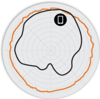
Abbildung 3. T750 5 GHz-Azimet-Antennenmuster
