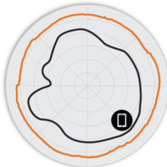
Abbildung 4. T750 2,4 GHz-Elevation-Antennenmuster
