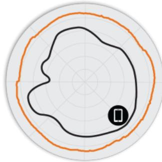
Figura 4. R750 2,4 GHz: patrones de antena en elevación
