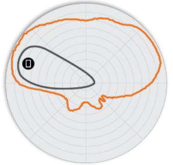
Nota: La traza exterior representa la huella RF compuesta de todos los patrones de antena BeamFlex+ posibles. La traza interior representa un patrón de antena BeamFlex+ dentro de la traza exterior compuesta.
