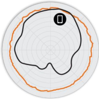
Figura 3. R750 5 GHz: patrones de antena en acimut
