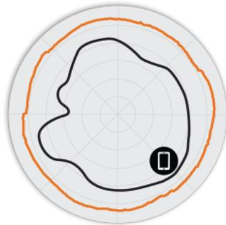
Рисунок 4. Вертикальная плоскость 2,4 ГГц R750
