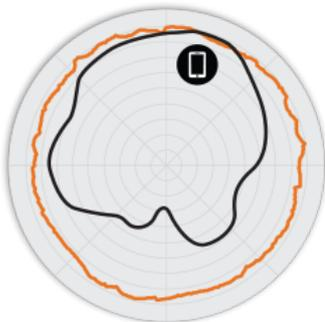
Figura 3. Padrões de antena do azimute R750 5 GHz
