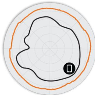
Figura 4. Padrões de antena de elevação R750 2,4 GHz
