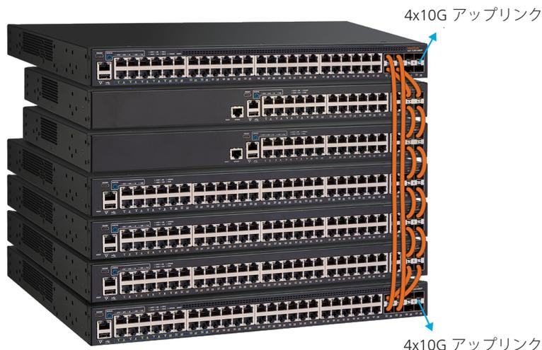
図 1: スイッチあたり最大 4 個の SFP+ 10 Gbps ポートを使って、アグリゲート スタッキング帯域幅 480 Gbps のフル冗長バックプレーンで最大 12 基の Ruckus ICX 7150 スイッチをスタックできます。
