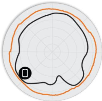
Figura 3. Padrões de antena do azimute 5 GHz
