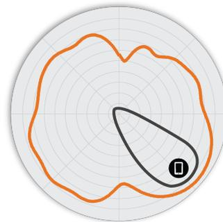
Figura 5. Padrões de antena de elevação R550 5 GHz
