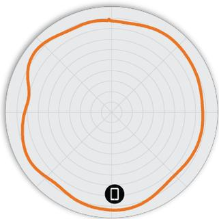
Figura 3. Padrões de antena do azimute R550 5 GHz
