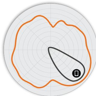
Figure 5. Diagrammes d'antennes Élévation R550 5 GHz
