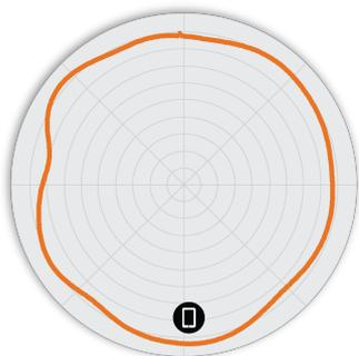
Figure 3. Diagrammes d'antennes Azimut R550 5 GHz
