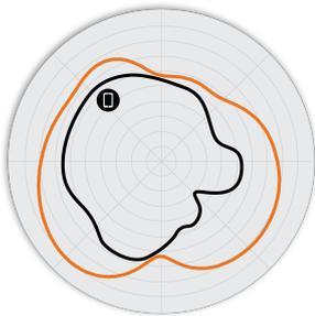
Abbildung 3. R350 5 GHz-Azimet-Antennenmuster
