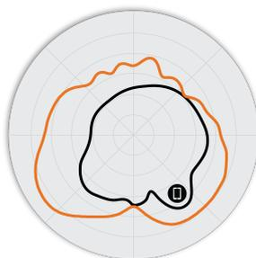
Abbildung 4. R350 2,4 GHz-Elevation-Antennenmuster
