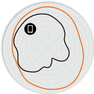
Figura 2. Padrões de antena do azimute H550 2,4 GHz
