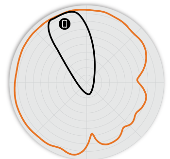
Figura 5. Padrões de antena de elevação H550 5 GHz
