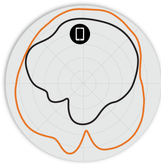
Figura 3. Padrões de antena do azimute H550 5 GHz
