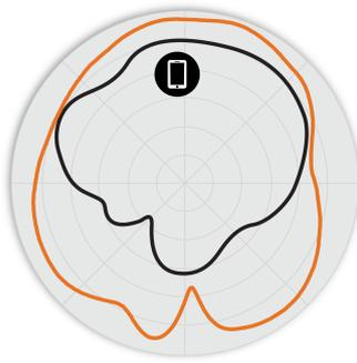
Abbildung 4. H550 2,4 GHz-Elevation-Antennenmuster
