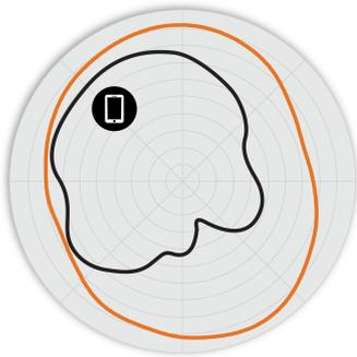
Abbildung 3. H550 5 GHz-Azimuth-Antennenmuster
