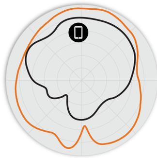
Figure 4. Diagrammes d'antennes Élévation H550 2,4 GHz
