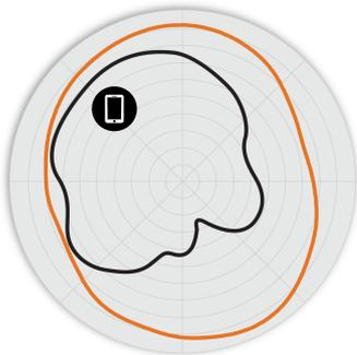
Figure 3. Diagrammes d'antennes Azimut H550 5 GHz
